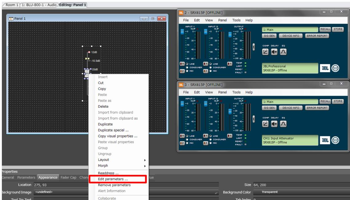
カスタムパネルの「Fader」を選択し、右クリックで「Edit parameters」を選択します。
