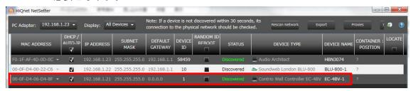
GPIOとは違い、HiQnet を使いますので NetSetter 上で認識していることを確認します。
