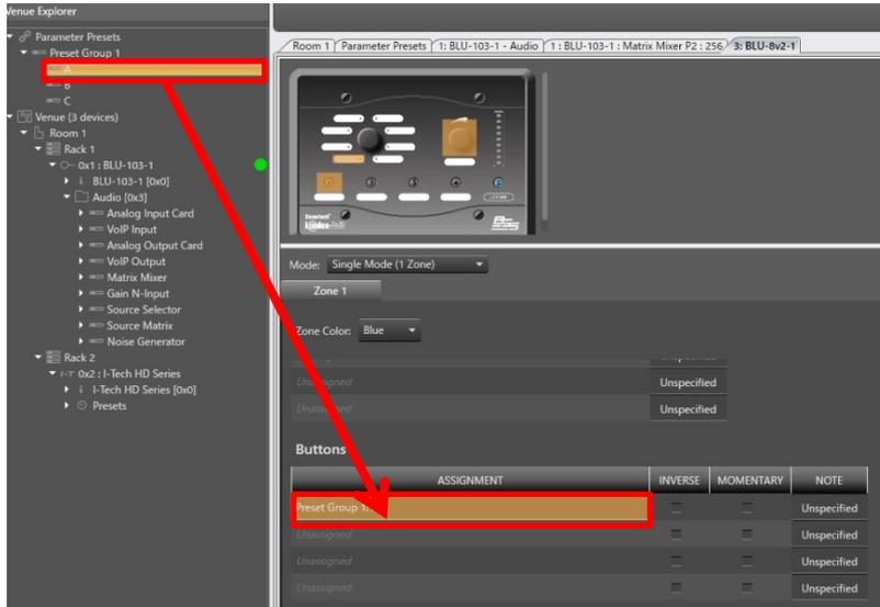
但し、作成した Preset をダイレクトにアサインすると、今どのプリセットが立ち上がっているのか、状態（選択されているプリセットボタンを自照させる）を確認することができません。そこで、ロジックを組むことで、BLU8v2 コントローラー4つのボタンで状態表示させつつ、システム起動時に特定のプリセットで毎回立ち上げることも可能です。
