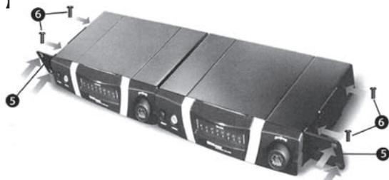
受信機の寸法以上に奥行きのあるラックに設置する場合は、オプションのフロントパネルマウントキットを使用して、アンテナをラックマウント金具前面に取り付けてください。
