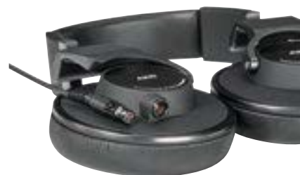
イヤークラッドを回転させて薄くコンパクトにできる
