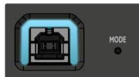
スイッチを押すと、モードによりUSBポートのLED色が以下のように変わります。色が変わるまでスイッチを長押し（約10秒）してください。この設定は、BLU-USBの電源が切れても継続されます。
