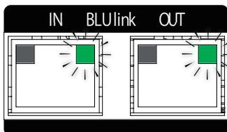
BLU link のクロックを受信しておらず、音声信号のやり取りができない状態です。BLU link ポートの [IN] と [OUT] が逆に接続されているか、または BLU link のサンプリングレートが他のネットワーク上のデバイスとマッチしていない可能性があります。
