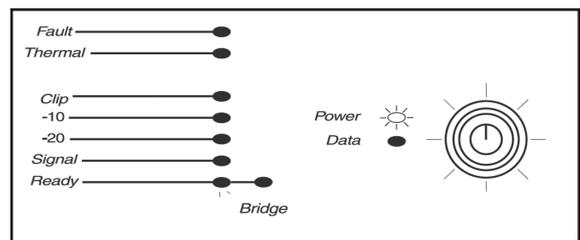
**状態：入力信号が検知されない（READY インジケータが点灯しているが、SIGNAL インジケータが点灯していない）。**
