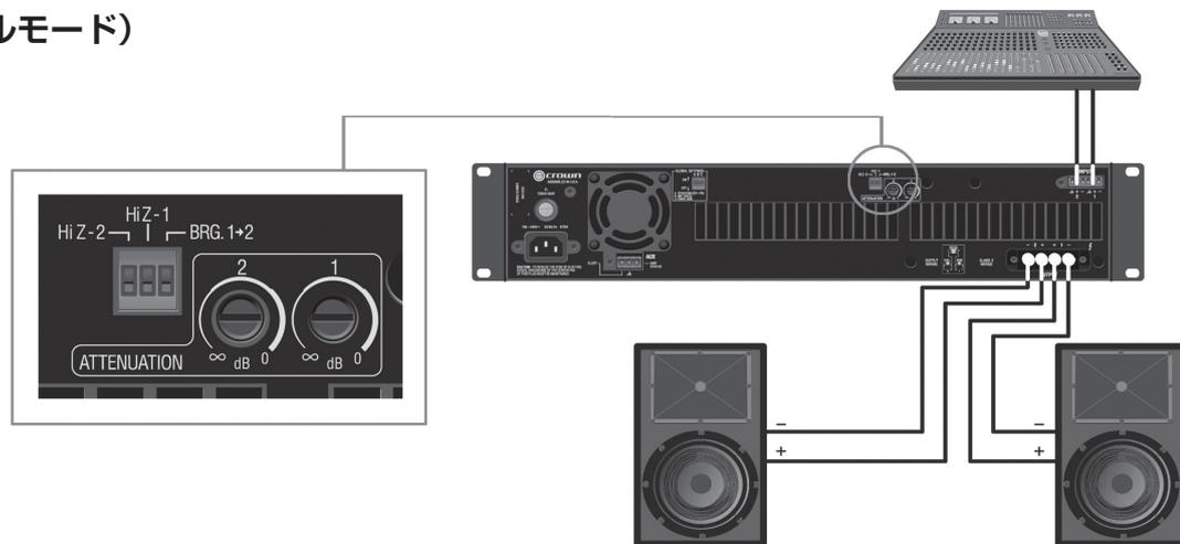
チャンネル設定 DIP スイッチの Hi-Z スイッチは下、BRG. スイッチは下にしてください。
