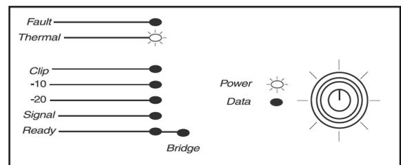
**状態：FAULT インジケータが点滅している。**
