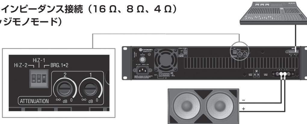
チャンネル設定 DIP スイッチの Hi-Z スイッチは下、BRG. スイッチは上にしてください。
