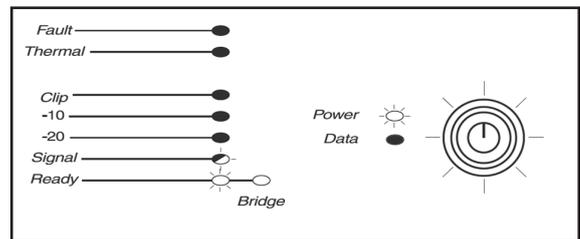
**状態：FAULT インジケータが点灯、CLIP/-10/-20/SIGNAL インジケータが点滅している。**
