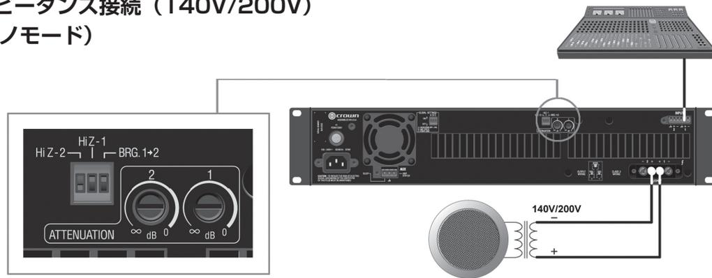
チャンネル設定DIPスイッチのHi-Zスイッチは上、BRG.スイッチは上にしてください。自動的に35Hzのハイパス・フィルターが挿入されます。チャンネルペアの偶数番号のチャンネルは使用しませんので、Hi-Zスイッチは下にしてください。
