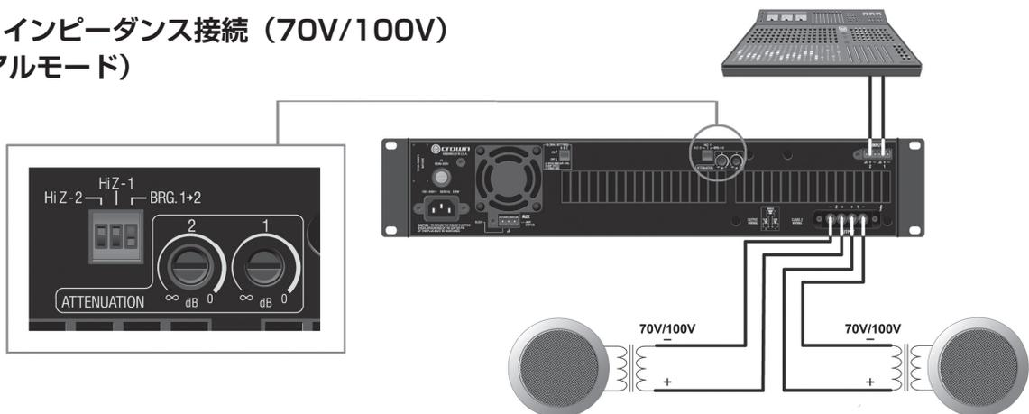
チャンネル設定 DIP スイッチの Hi-Z スイッチは上、BRG. スイッチは下にしてください。ハイ・インピーダンス接続モードとロー・インピーダンス接続モードは、チャンネルごとに設定できます。ハイ・インピーダンス接続モードに設定したチャンネルには自動的に 35Hz のハイパス・フィルターが挿入されます。
