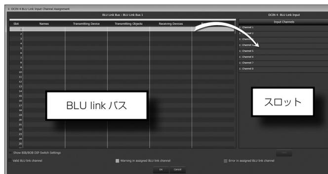
次に、開いている [Source Routing] パネルで、ドロップダウン・リストから、BLU link バスを割り当てたスロットを選択します (BLU link Input 1 ~ 8 のいずれか)。この設定により、BLU link バスが本機のチャンネルに割り当てられます。
