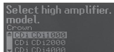
16. パワーアンプの推奨ゲイン設定が表示されるので、高域(high)用パワーアンプのアッテネーターを調整してください。調整が完了した後、ホイールつまみを押ししてください。パワーアンプにCrown(AMCRON)のI-Tech Seriesを選択した場合は、この項目はスキップされます。
