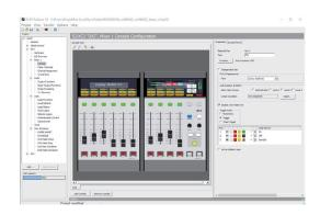
コンフィグレーションソフトウェア「Toolbox」によるフ ルカスタマイズ、ミキサーの構成、IO BOXの構成、 音声バス構成、ロジック回路などミキサーに必要な 機能をToolboxによりカスタマイズします。
