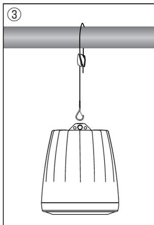
④ スピーカーの高さを調整します。下げる場合は GRIPPLE のロックを解除する必要があります。スピーカーが落ちないように押さえながら、GRIPPLE の左右両側面にある小さな穴のどちらかにリリースキーを差し込んで、押してください。差し込んだ側にある楕円形の穴のワイヤーのロックが解除されます。上げる場合はロックを解除する必要はありません。
