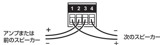
左図の接続方法では、ユーロブロックコネクタをスピーカーから取り外すと、それ以降のスピーカーはパワーアンプから切り離されるため、動作しなくなります。トラブルの特定および対処に有効です。
