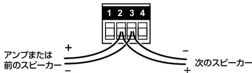
左図の接続方法では、万が一、あるスピーカーにトラブルが生じた場合でも、ユーロブロックコネクタにケーブルが接続されていれば、そのスピーカーを取り外しても他のスピーカーは正常に動作します。
