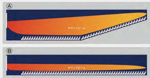
放射音の形を自在に変えられるので、傾斜に客席が配置されている会場(④)や天井が低い会場(⑤)でもクリアな音質を実現できる。
