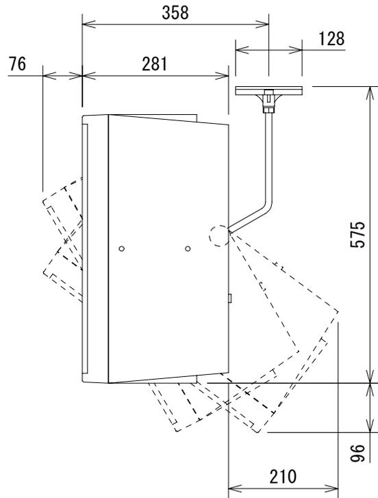
注) スピーカを縦取り付けの場合は、ツイーターを下向きで使用して下さい。
