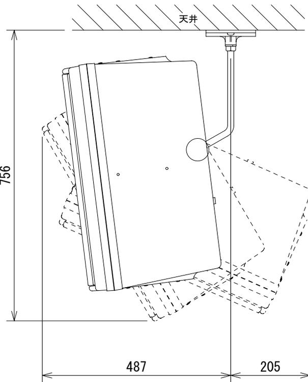
注) スピーカを縦取り付けの場合は、ツイターを下向きで使用して下さい。
