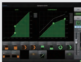
ゲート、コンプレッサーの操作画面
