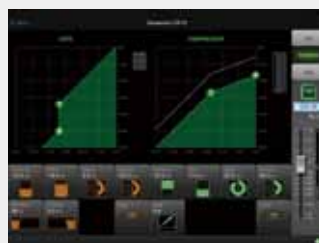
ゲート、コンプレッサーの操作画面
