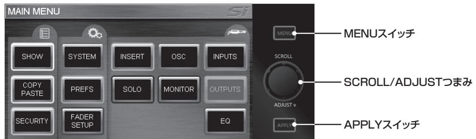
タッチスクリーンの項目の操作は、基本的にMENUスイッチ、SCROLL/ADJUSTつまみ、APPLYスイッチ、およびタッチスクリーンへのタッチで行います。また、特定のチャンネル/バスに関する設定を行う場合は、そのチャンネル/バスのSELスイッチを押します。
