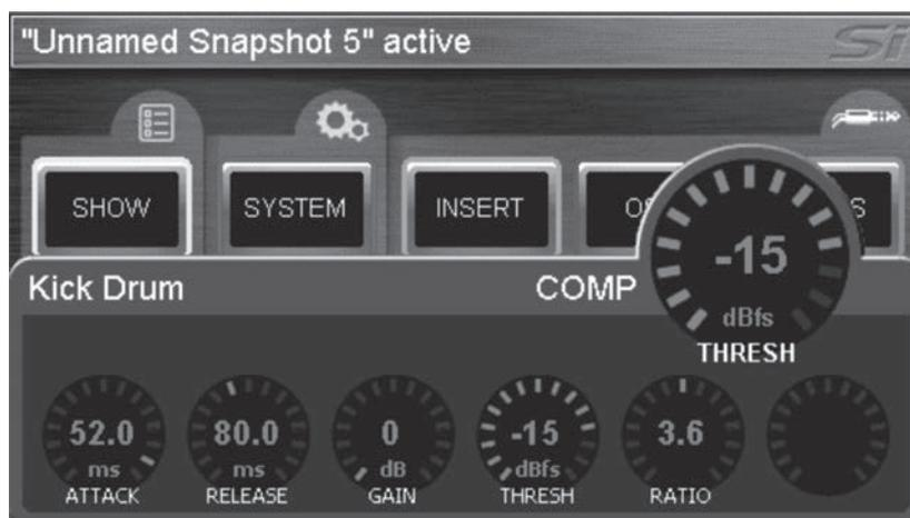
ファンクションフォーカス機能は、ほとんどのコントロールグループで使用できます。上のスクリーンショットは、「Kick Drum」チャンネルのコンプレッサー設定の例です。調整中の項目 (THRESH) は大きい円形パネルに表示され、グループ内の他の項目は全て画面下部の小さい円形パネルに表示されます。
