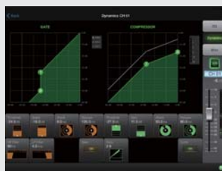
ゲート、コンプレッサーの操作画面
