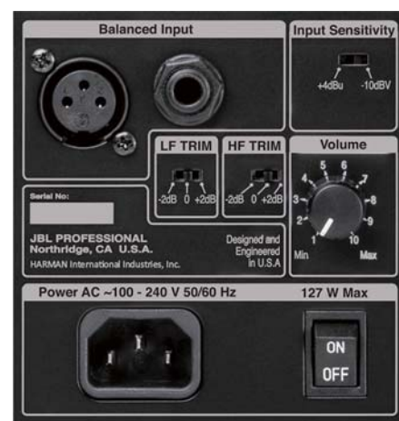
背面パネルには、低域と高域のそれぞれにレベルを±2dB変更するTRIMスイッチや入力感度の切り替えスイッチを搭載
