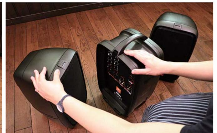
ミキサーとスピーカーを分割します。スピーカー上部にあるボタンを押すと連結の解除が可能です
