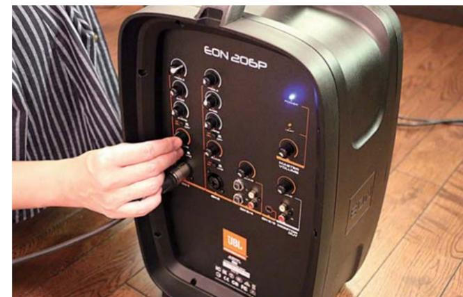
電源を入れ、ボリュームを上げます。接続する機材を確認し、「MIC/LINEスイッチ」を操作します
