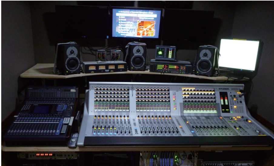
中継音声支援車「S-1」内の VISTA 5 SR
