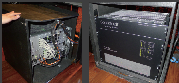
▲ Vi7000 のローカルラックは引き出して回転させることができ、メンテナンスが容易に行える。
